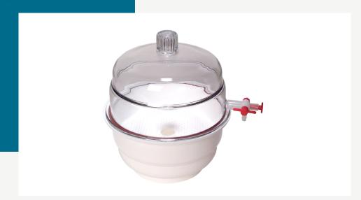
Vacío, base blanca, PP/PC Estos desecadores esterilizables en autoclave están hechos de polipropileno (PP) y policarbonato (PC) y pueden contener un vacío de hasta 740 mm Hg durante 24 horas sin necesidad de engrasar. Esterilizable en autoclave a 121 °C durante 15 minutos. La cúpula superior, moldeada en PC rígido y transparente, ofrece una visión nítida de la muestra. La perilla moleteada en la parte superior facilita el manejo del domo.
