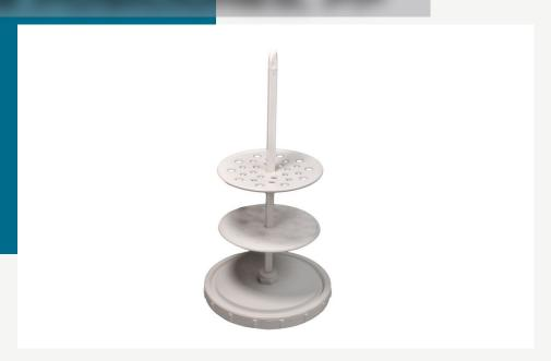
El soporte para pipetas de polipropileno no corrosivo puede contener hasta 28 pipetas. La base pesada tiene 9cm de diámetro y la barra cuadrada recubierta de polipropileno tiene 15cm de altura. El disco superior tiene orificios guia donde descansan las puntas de las pipetas y los liquidos pueden drenar hacia la base. La distancia entre los discos se puede ajustar para acomodar varias longitudes de pipeta.
