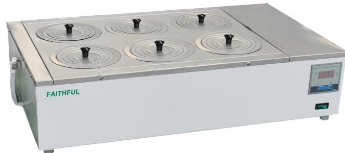
Se utiliza para temperatura constante de precisión y auxiliar. Este dispositivo es ampliamente utilizado para evaporación, secado, concentración y calentamiento a temperatura constante en laboratorios escolares, procesamiento de alimentos, fábricas de aceite, bioquímica, agricultura, etc.
