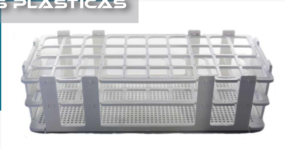
Gradillas económicas pero muy duraderas que son sumergibles, esterilizables en autoclave y se apilan fácilmente cuando están vacíos. Fabricados con una mezcla especial de polipropileno (PP) que los hace hundirse en un baño de agua y mantener su estabilidad incluso en agua agitada. El nivel superior presenta una referencia de cuadrícula alfanumérica.
