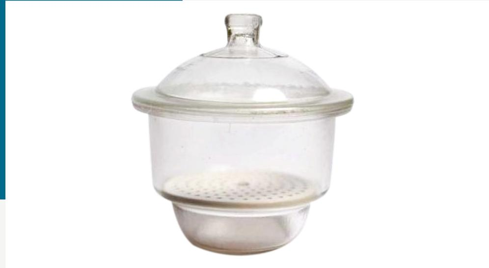
Estos desecadores transparentes sin vacío están fabricados con vidrio de borosilicato e incluyen una tapa de vidrio de borosilicato con una perilla moldeada. El vidrio transparente proporciona una excelente visibilidad y se puede esterilizar en autoclave. Los bordes del desecador y la tapa son de vidrio esmerilado y requieren engrase antes de su uso para crear un sello hermético.
