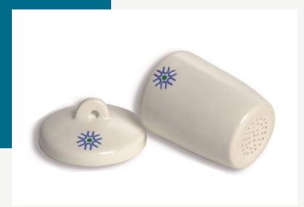
Los crisoles de Gooch tienen un fondo perforado e incluyen tapas. Los crisoles están vidriados en las superficies interior y exterior excepto en el borde y el fondo exterior. Se utiliza para la determinación de sólidos suspendidos totales.
