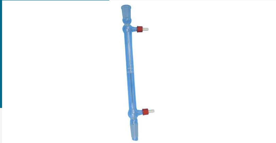
Los condensadores Liebig se utilizan para enfriar y condensar aparatos de destilación de varte vita caliente. Este condensador tiene un tubo interior recto por el que pasa el vapor de condensación y una camisa exterior más grande por la que pasa el agua de refrigeración. El zócalo es 24/40 con un conector roscado.
