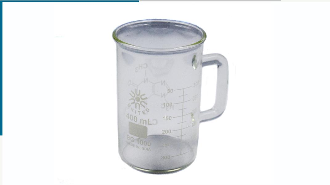
Estos vasos de precipitados de vidrio de borosilicato tienen un asa adjunta y un borde liso. La estructura molecular de la cafeína está esmaltada en blanco en un lado y el otro lado tiene graduaciones métricas duales.
